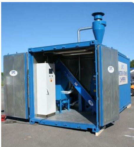
Figur 15. Minianläggning för pelletering för ca 150 kg/h byggd i en 20" container från SPC, Sweden Power Chippers. ( www.pelletpress.com )
