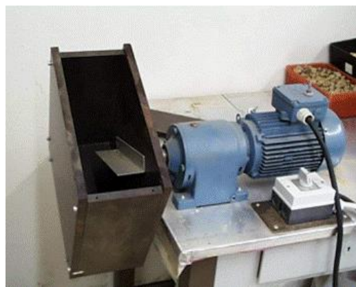
Figur 20. Exempel på standardiserad hållbarhets-testare för pellets som skall rotera i 10 min med 50 varv/min
